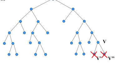
**Compare:** #Errors(V) < #Error(V') + #Errors(V'')
